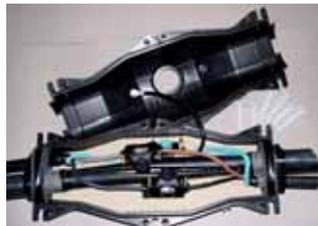
L'enveloppe et toutes les fonctions du câble sont reconstituées grâce à de la résine coulée dans une coquille rigide plastique complétée d'une coquille métallique assurant la protection des tiers.
